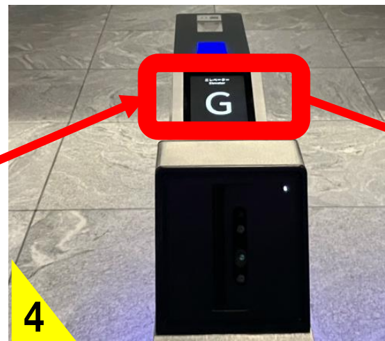
赤枠にエレベーター番号 (A～H)が表示
