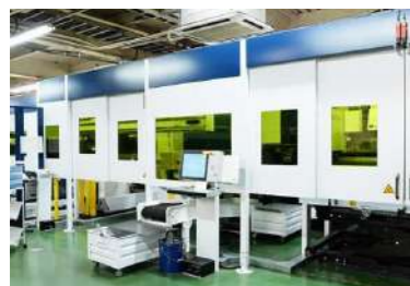
大径・長尺パイプの加工が可能な BLM社製3Dパイプレーザー加工機
