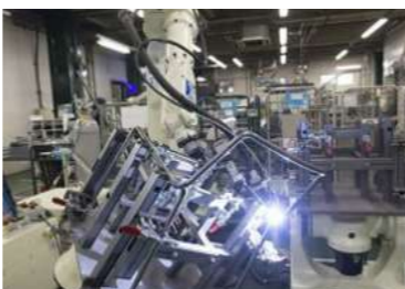
ロボット溶接機と熟練技術を使い分けて 生産性向上と高品質を両立
