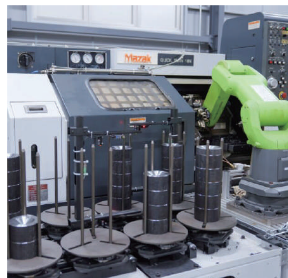
社内で設置しているワークstocker装置×協働ロボットシステム（展示機かつ、社内で自動化装置として稼働中）
