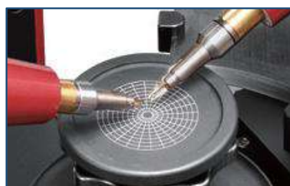
精密・微細加工の後工程である組立まで、マイクロハンドの設備投資を行い自社内に取り込んでいる
