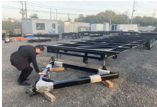
この車輪がついた鉄骨を海外から安く仕入れて、製造場所（ヤード）へ納品し、簡単な組み立てをして上棟をしているイメージです。世の中には架台（シャーシ）が国内産・自社製造の会社もあるのですが、私たちは海外産の輸入一本で考えてます。
